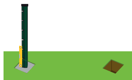
2. Sceller le premier poteau et le mettre à l'aplomb à l'aide d'un niveau.
